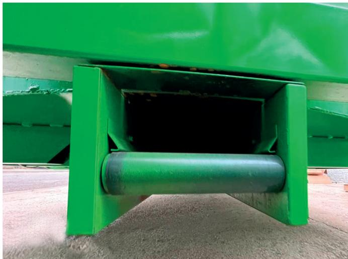
Equipado de serie con una cinta de descarga en la parte inferior del secador, se realiza la descarga suave y rápida sin maltratar el producto, sin saltos de almendra ni atranques. Así podemos descargar el fruto de manera muy cómoda. A diferencia de otras marcas y modelos que lo hacen a través de una compuerta manual, siendo un trabajo más costosos en todos los sentidos.
