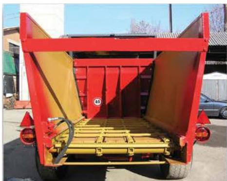
Lado trasero móvil con avance automático, accionado por cadenas para productos semi-densos
