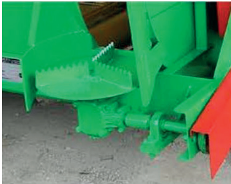
Placa localizadora con pie de alambre tipo mecánico con inclinación manual
