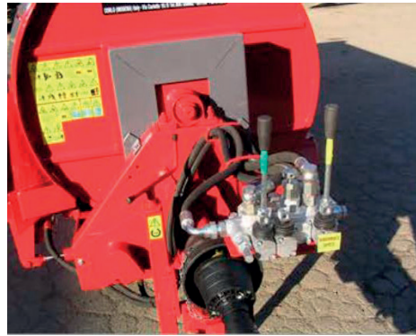
Sistema hidráulico independiente con bomba y depósito
