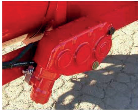
Válvula anti-choque y alimentación por correa hidráulica de velocidad ajustable
