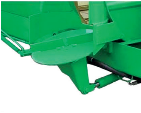
Inclinación hidráulica de la placa hidráulica
