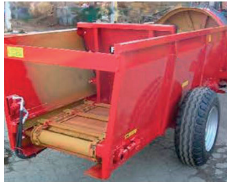
Lado trasero móvil con alimentación automática, accionado por cadenas
