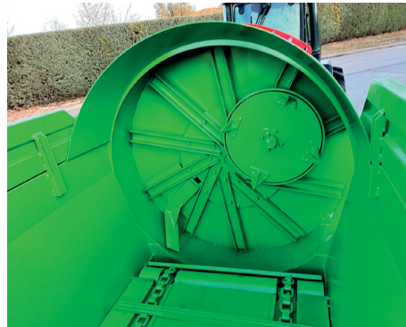
Esparcidor con rotor de corte y cuchilla raspadora
