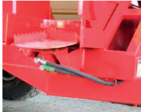
Placa localizadora con pie de alambre tipo hidráulico, con inclinación manual
