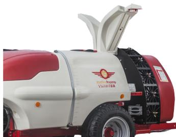
Tapas laterales desmontables para permitir un fácil acceso al interior del equipo para el engrase, cambio de aceite, etc.
