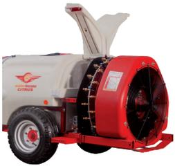
Tapas laterales desmontables para permitir un fácil acceso al interior del equipo para el engrase, cambio de aceite, etc.
