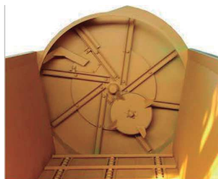
TURBINA CON TRITURADORA Y CUCHILLO RASPADOR
