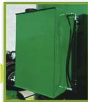
Tanque de combustible
